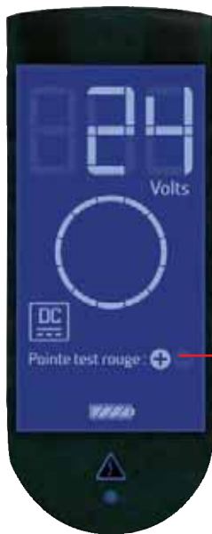
Exemple de détection de tension continue de 24 V, affichage en BLEU car < 50 V.
